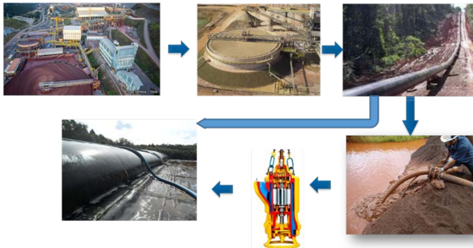
Figura 7 - Fluxo de disposição: da usina de processamento à bolsa geossintética
