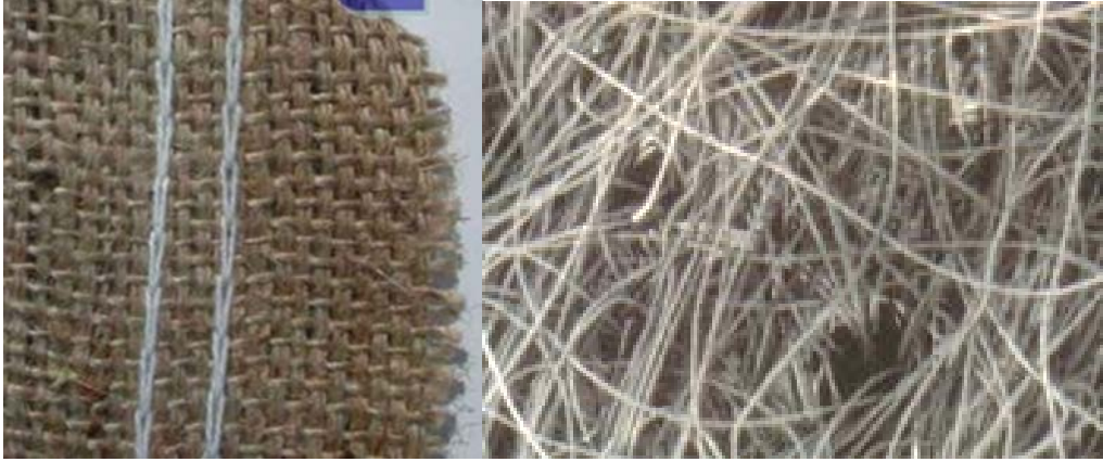
Figura 4 - Geossintético tecido (esquerda) e o não-tecido (direita)
